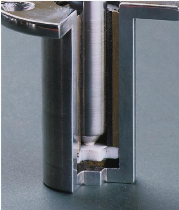
Eine Keramikugel läuft auf einem Teflonspiegel: mit Kunststoff ausgekleidetes Lager des Solid Machine.
